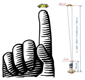
Rys. 2.5. Określanie odległości za pomocą twierdzenia o trójkątach podobnych
